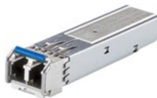
Оптические трансиверы в стандартных металлических корпусах модулей SFP с отдельным оптическим входом/выходом под разъемы типа LC для передачи сигнала по двум оптическим волокнам. Кроме того, имеются SFP модули для промышленных коммутаторов, поддерживающие диапазон температур от -40 до +85° С.
