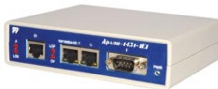
**Назначение:** передача трафика Ethernet (10/100BASE-T) в потоке E1.
