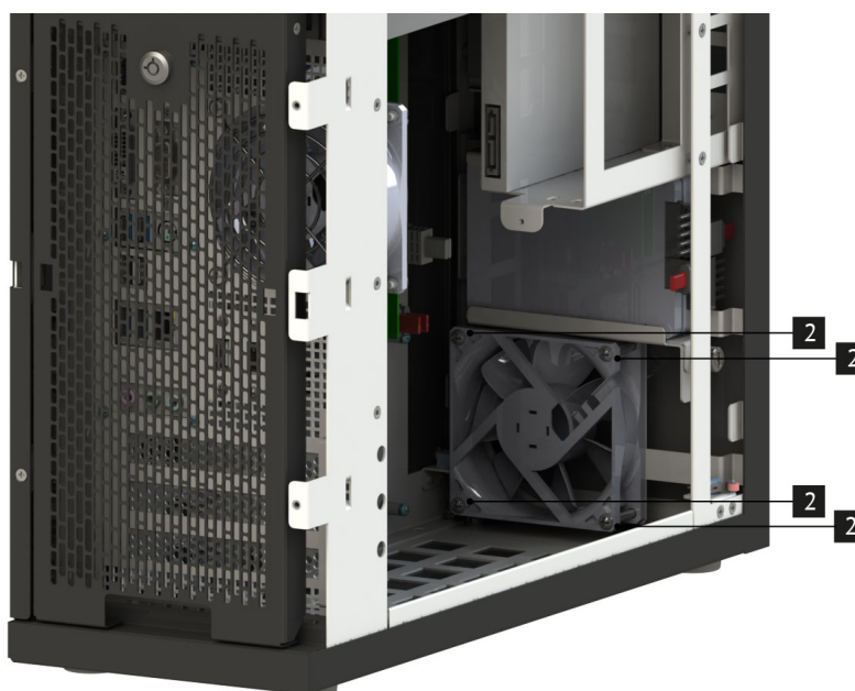
Рис. 18. Установка вентилятора на переднюю панель рабочей станции
