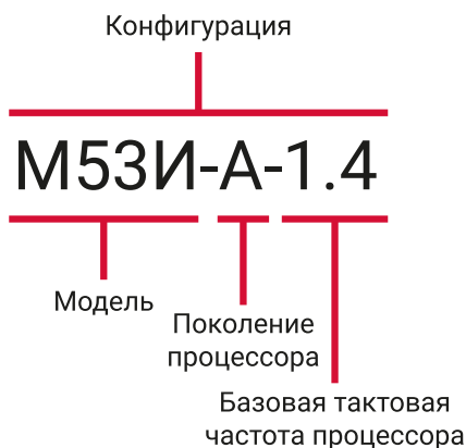
Рисунок 1 – Пример обозначения конфигурации моноблока
