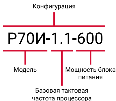
Рисунок 1 – Пример обозначения конфигурации РС «Гравитон»
