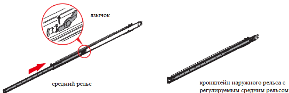
Рисунок 11 – Установка направляющего рельса-2
